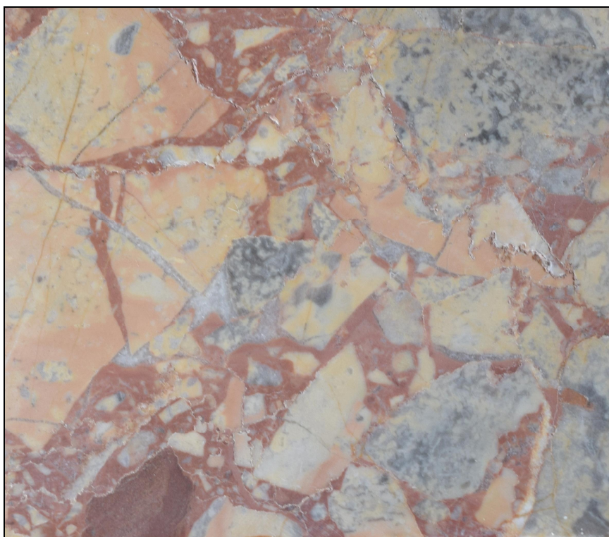
Slika 33. Fotografija poliranog uzorka kre njakih bre a sa lokaliteta Mratini i kod Krezeva (foto Hajdarevi , 2012.)
