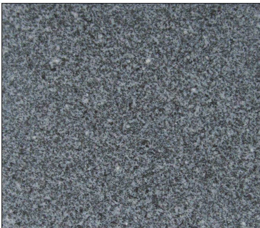
Slika 12. Fotografija poliranog uzorka gabrodiorita sa le0izta Stajizte (foto Hajdarevi , 2014.)
