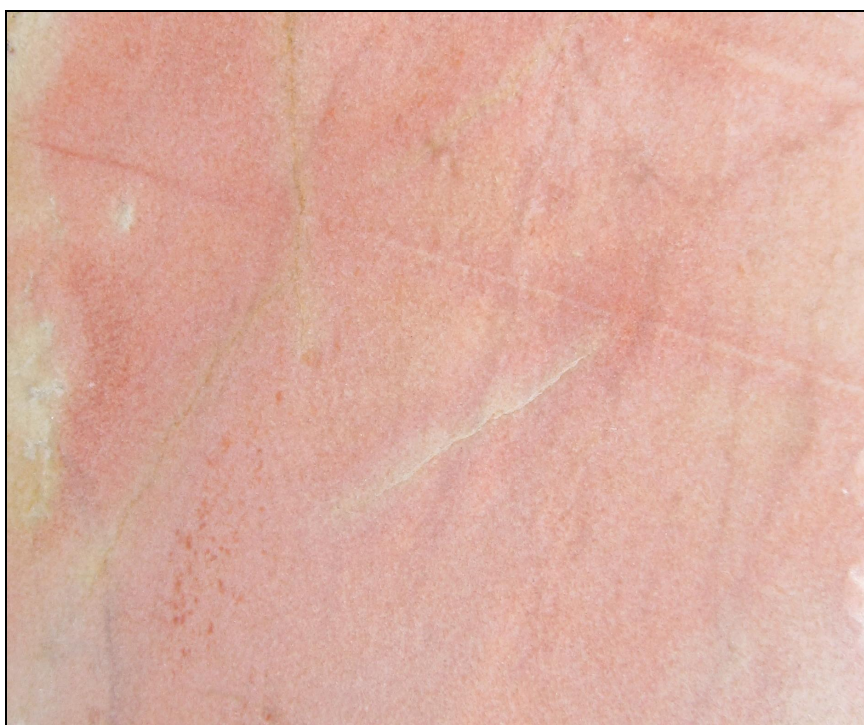
Slika 36. Fotografija poliranog uzorka rumenkastog mermera sa lokaliteta Gornje pešterine kod Novog Travnika (foto Hajdarević, 2013.)
