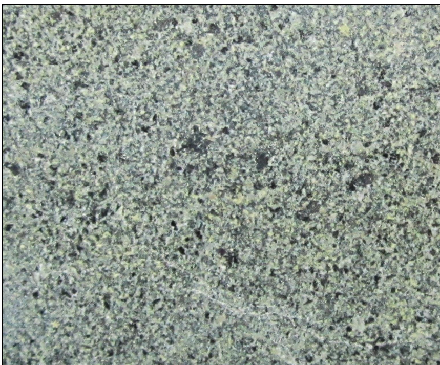
Slika 35. Fotografija poliranog uzorka amfibolskog kvarcdiorita sa lokaliteta Rakovica u blizini Rostova, općina Bugojno (foto Hajdarevi, 2013.)
